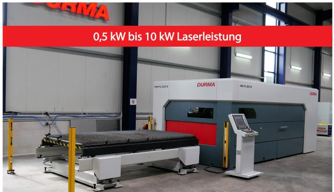
Mit ihren schnelleren Schneidvorgängen und ihrer höheren Energieeffizienz überholen die Fiber-Lasermaschinen die CO2-Laser. Wir bieten Ihnen Qualität, Leistung und Effizienz. Die von uns eingesetzten Servomotoren, Motoren mit Zahnstangenantrieb (HD-F Serie) und Linearmotoren (HD-FL Serie), ermöglichen es Beschleunigungswerte von 3G und mehr zu erreichen.
