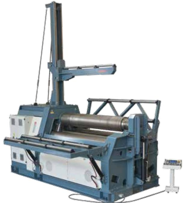
Von den Standard Blechstützsystemen, kann in das Doppelseitenausstützsystem eingegriffen werden und wenn die Größen dieser Stützen auf den Anspruch der Kunden hergestellt werden, wird eine Präzise und hervorragende Biegung gewährleistet.
